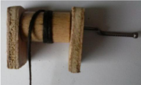
Nouer la ficelle autour du treuil et l'enrouler de quelques tours.
