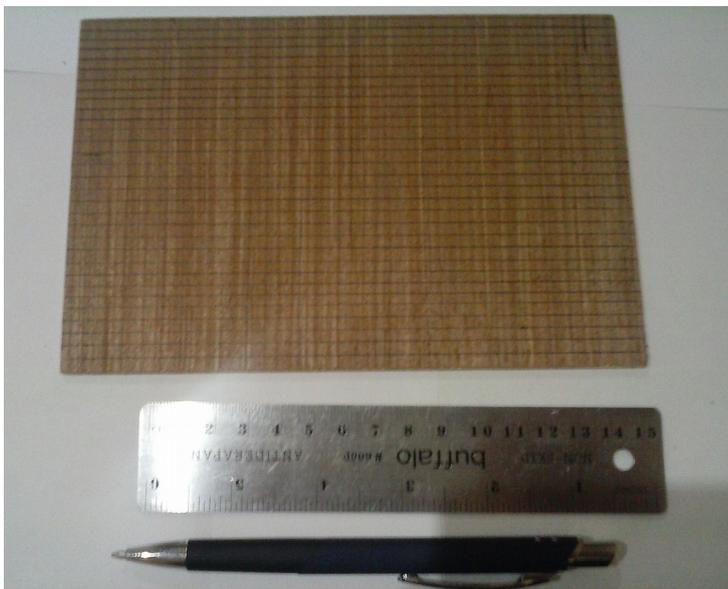
Tracer les lames de plancher parallèlement au grand côté, tous les 5mm environ
